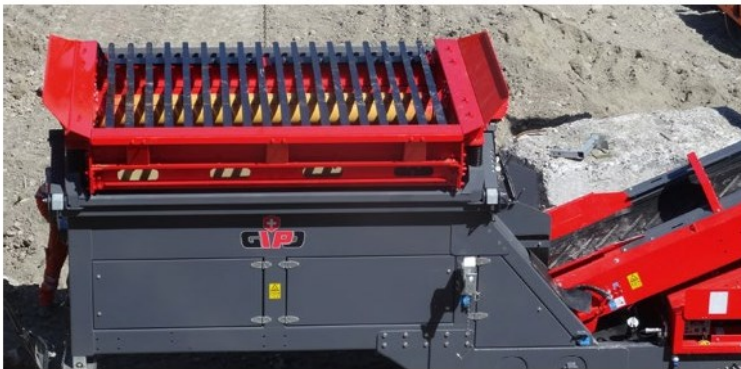
Aufgabetrichter mit Kipprost / Feed hopper with grid opening / Trémie d'alimentation avec grille basculante
