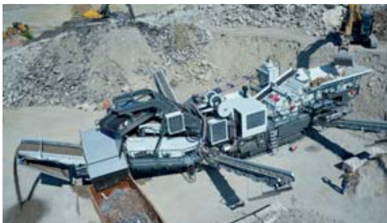
Le GipoKombi RC130FDR offre jusqu'à quatre granulométries de matériaux. Les overbands alimentent une benne dédiée aux métaux ferreux.
